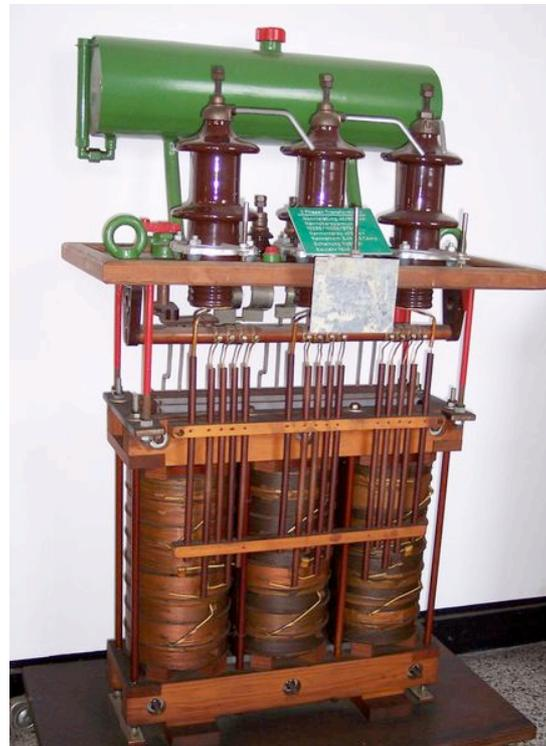
Wenn bei angelegter elektrischer Spannung an der Primärspule kein Strom aus der Sekundärspule des Transformators entnommen wird, wird dies als „Leerlauf“ oder „unbelasteter Betrieb“ bezeichnet.
